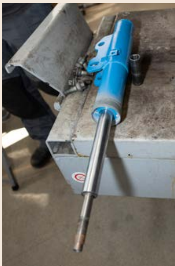
En kreativ konstruktion, en fläns tillverkad av en bit rör, centrerar hjälpfjädern på den främre stötdämparen.
