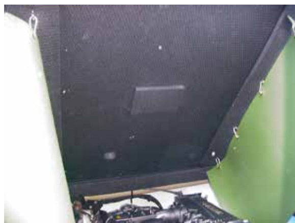
Demonterbar motorhuv med dämpgardiner på sidorna och ljudabsorbent både på huvan och runt omkring.
