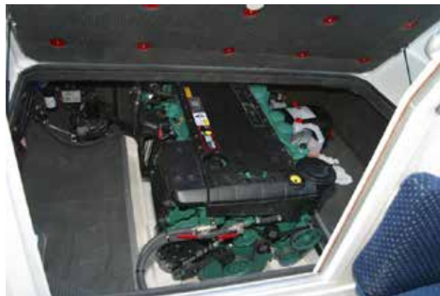
Välisolerat motorrum i en Segmo 31.
