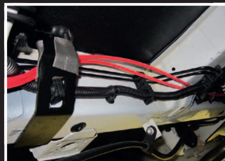
Luftslangarna måste skyddas mot nötning.
