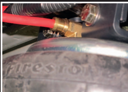
Slangen är bara att trycka in i nippel på luftbälgarna.
