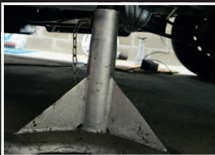
Stabila pallbockar är ett måste.
