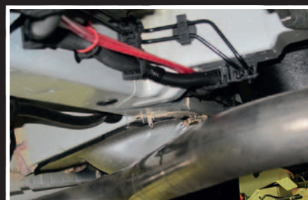
Var noga med att slangarna inte kommer nära avgasröret.
